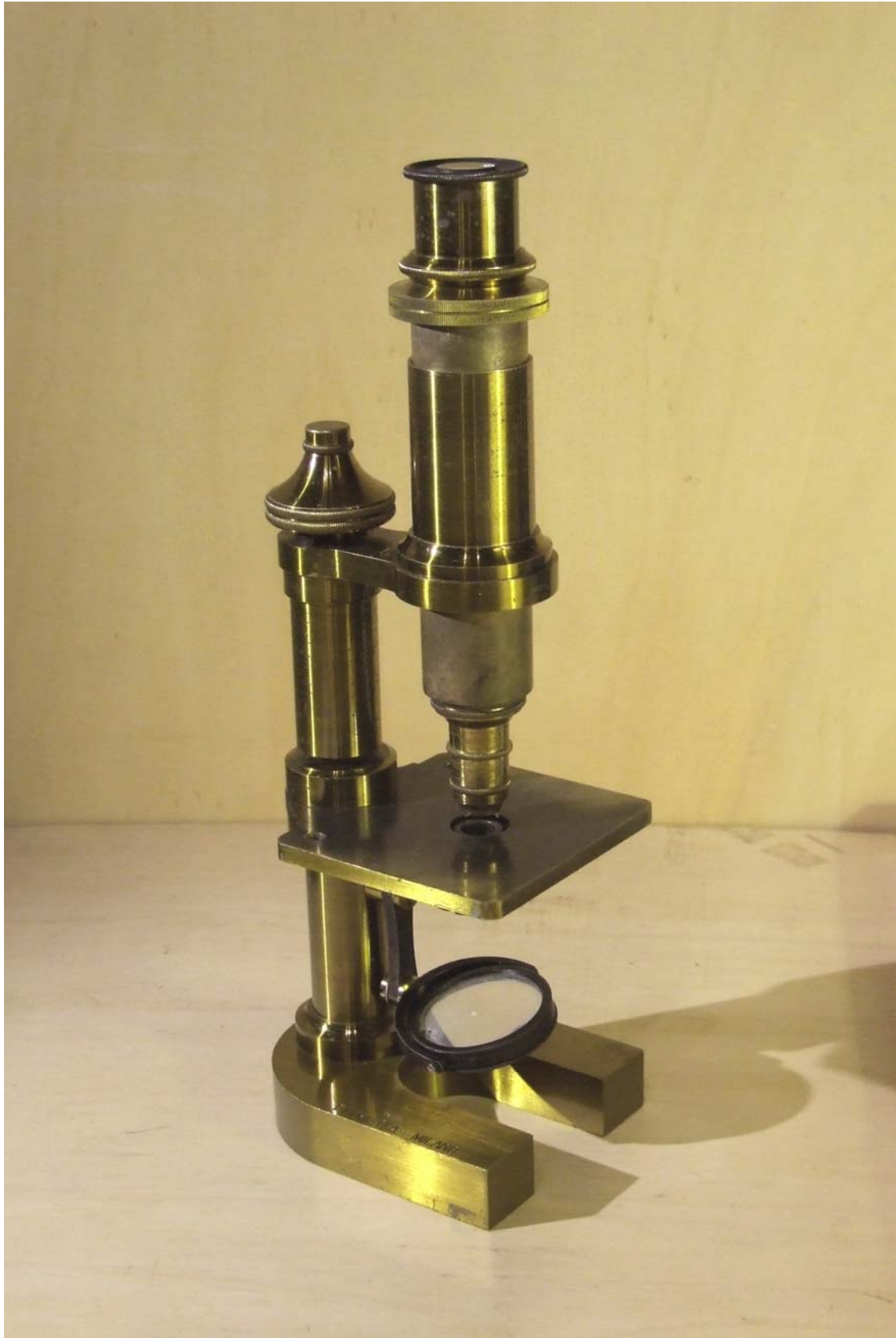
Stativo economico di fine '800 della casa milanese F.lli Koristka (nome inciso sulla base), imitato da analogo modello Zeiss. Manca un condensatore. Attraverso il foro del tavolino si vede il supporto dei diaframmi di campo "a cilindro". Il supporto dello specchio è decentrabile per consentire l'illuminazione obliqua. Manca la vite macrometrica; la micrometrica è coassiale colla colonna. Il tubo è telescopico e munito di graduazione.
