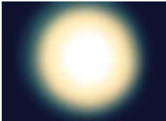
Fig. 13 – Immagine del diaframma di campo, quale appare usando un obiettivo forte ed un condensatore di Abbe semplice. La sfumatura è dovuta all'aberrazione sferica del condensatore, i colori all'aberrazione cromatica. L'oggetto è costituito da un vetrino vuoto.
