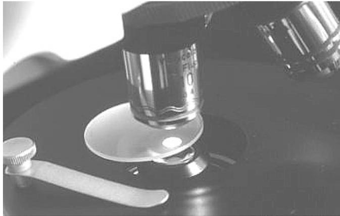
Fig. 12 – Immagine del diaframma di campo proiettata dal condensatore nel piano oggetto. In luogo del vetrino si è posto un vetro smerigliato; subito sotto, si vede la lente frontale del condensatore.
