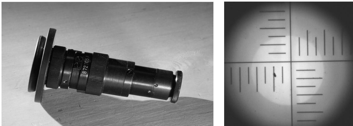
Fig. E – A sinistra: Esempio di cannocchiale di centramento, con coda di rondine (a sinistra) ed oculare (a destra, foceggiabile). La ghiera di messa a fuoco dell’obbiettivo è al centro.
