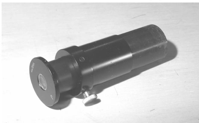
Fig: F – Esempio di oculare di centramento. La lente oculare è regolabile e bloccabile colla vite in basso; ciò consente di mettere a fuoco su distanze molto variabili, e cioè su tutto l'interno dello strumento. A sua volta, la distanza fra lente oculare e reticolo può essere variabile per consentire sempre una visione nitida del reticolo stesso.
