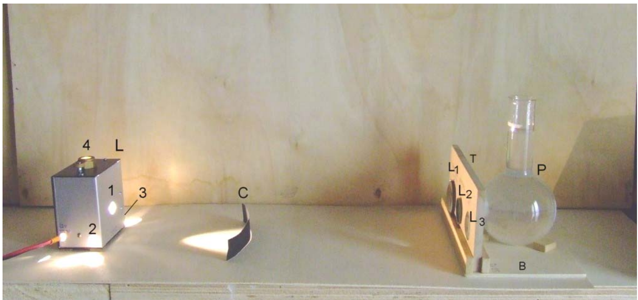
Fig. 200 - Disposizione generale per la simulazione del funzionamento ottico dell'occhio umano. La piastra T porta tre lenti di diversa potenza (L1, L2, L3).
