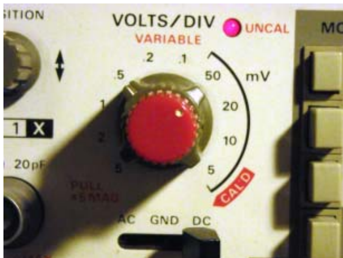
foto 1c - la regolazione dell'Asse Y.
